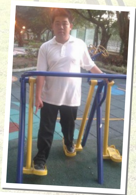
損壞的離地慢步機搖擺時會碰到旁邊的鐵架，容易令使用者受傷。
